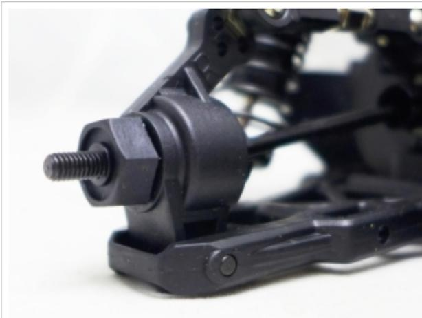
Radlager, durch einen Deckel abgedichtet; Quelle: [www.himoto.cz](http://www.himoto.cz)
