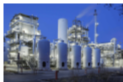
Obrázek 1: Průmyslová výroba vodíku parním reformingem. Reuter, Benjamin & Faltenbacher, Michael & Schuller, Oliver & Whitehouse, Nicole & Whitehouse, Simon. (2017). New Bus ReFuelling for European Hydrogen Bus Depots - Guidance Document on Large Scale Hydrogen Refuelling.
